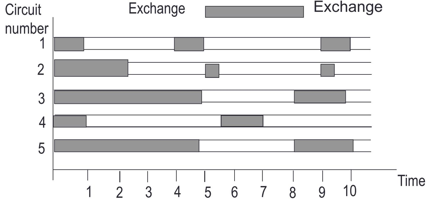
Route dari Sentral A dan Sentral B pada gambar di atas terdiri dari 5 circuit, masing-masing circuit mempunyai peta traffic seperti ditunjukkan pada gambar di bawah, selama periode 10 menit
